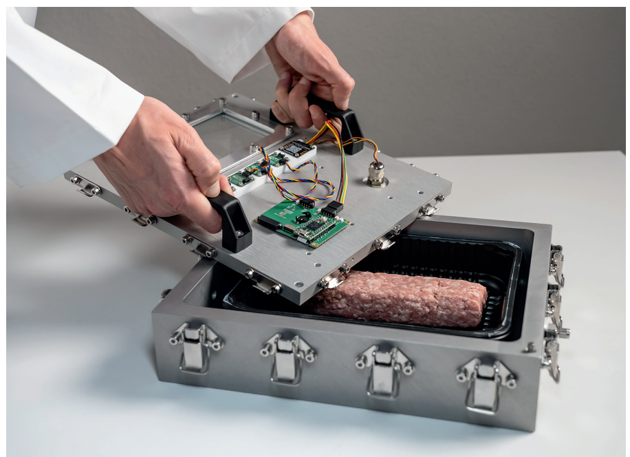
Abb. 1: Sensorische Analysenkammer SEAN: Die für das Projekt ZL2030 entwickelte Messkammer ermöglicht die simultane Messung von Feuchtigkeit, Temperatur und flüchtigen organischen Verbindungen in MAP-verpackten Fleischproben. ©Fraunhofer IVV
